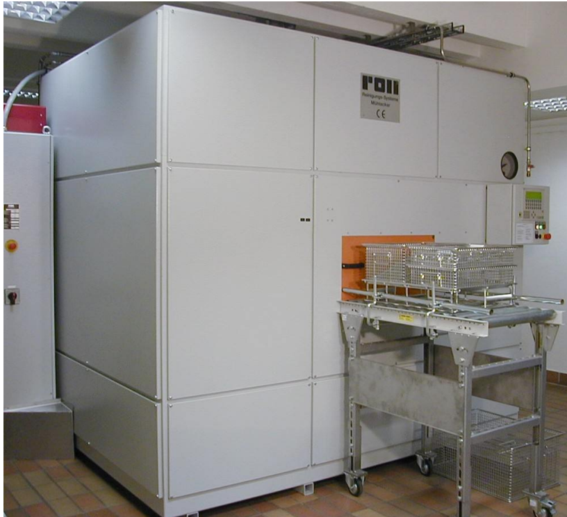
Illustration 1 : Vue générale de l'installation de nettoyage type REFVT avec système de chargement et de déchargement dans le laboratoire
