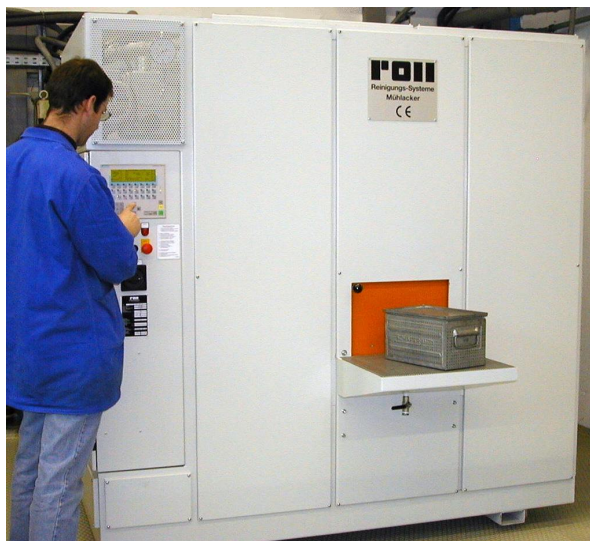
Photo 1: Installation de nettoyage à 1 chambre RCTS pour hydrocarbures
