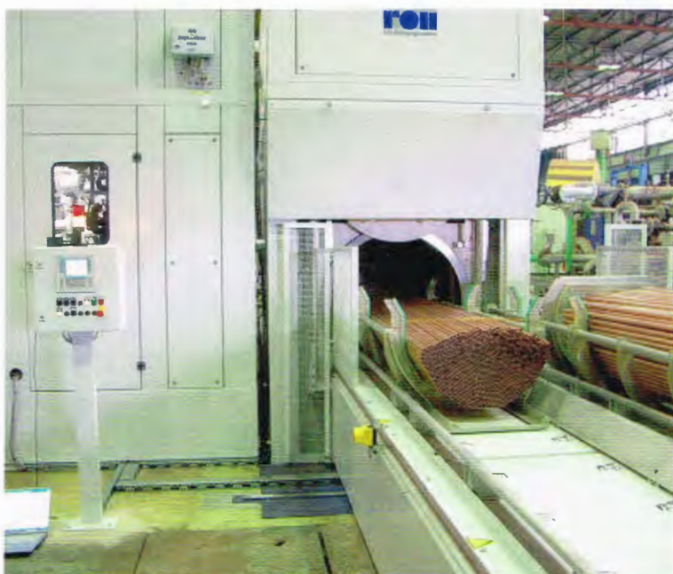
Das mit Perchlorethylen betriebene Reinigungssystem sorgt für eine zuverlässige Entfettung der Kupferrohre
