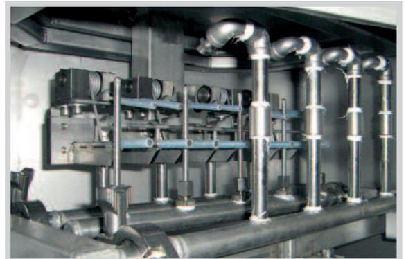
Teilespezifisch angepasste Düsenanordnung in den Sprühstationen
