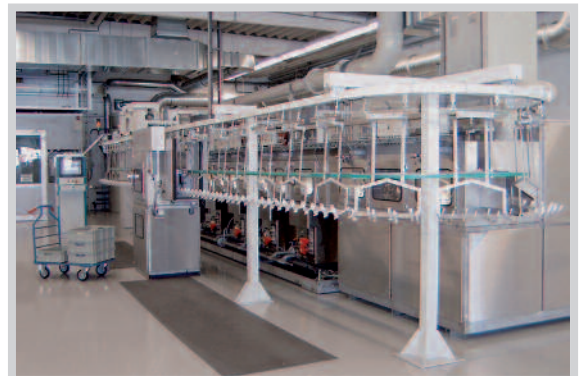
Durchlauf-Spritzanlage mit Hängeförderer
