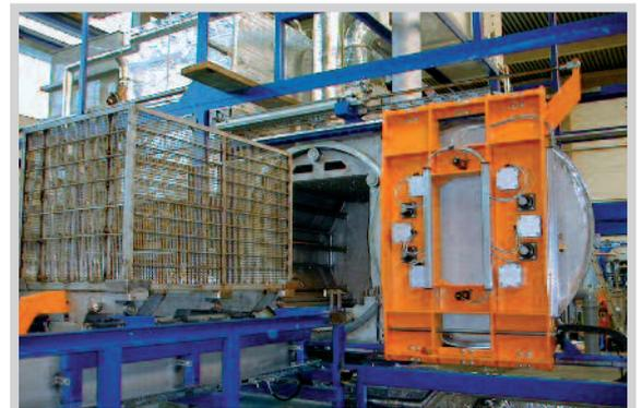
Sonderanlage zur Reinigung von Euro-Gitterboxen
